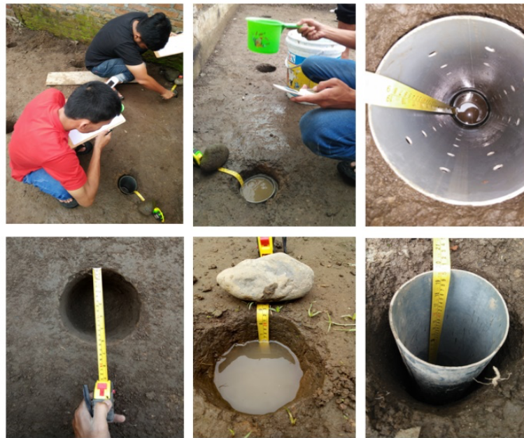
Gambar 7. Pengujian Permeabilitas laju Infiltrasi Lahan
