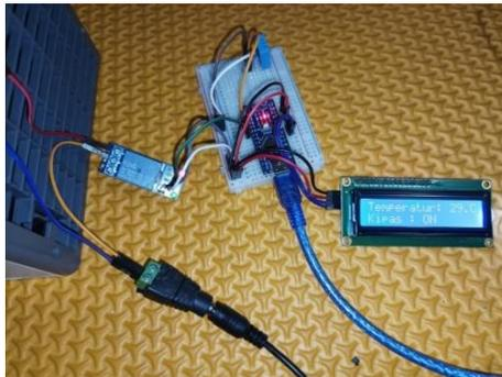
Gambar 10. Pendingin udara yang mulai bekerja dengan digerakkan mikrokontroler arduino
