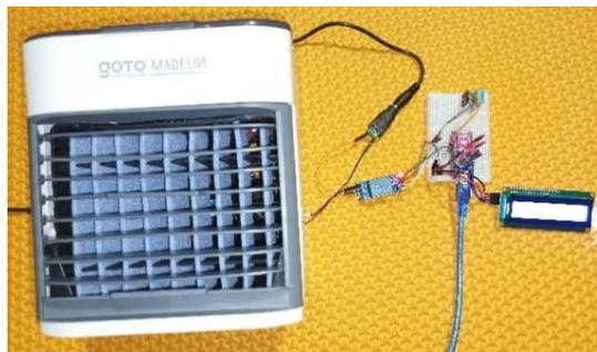
Gambar 9. Rangkaian alat pendingin udara otomatis
